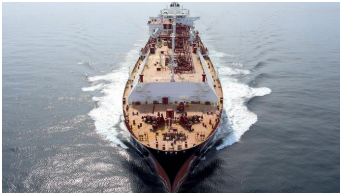
Fig. 2, FLEX LNG 174,000 m 3 LNG Carrier.
