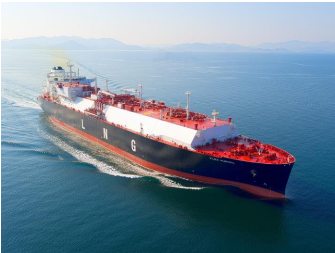
Fig. 6, FLEX LNG 174,000 m 3 LNG Carrier .
